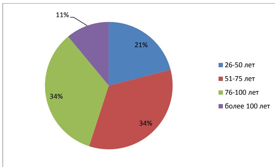
Рис. 1. — Возрастной состав гидротехнических сооружений на примере судоходных гидротехнических сооружений [Источник: 5].
